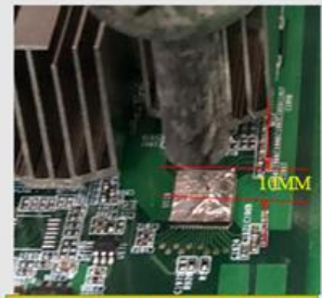
4.4. 风枪嘴和芯片表面的距离要保持在10MM，停留时间为16±4秒左右，可取掉芯片
