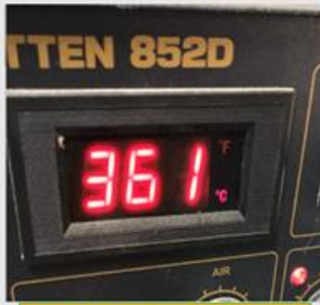
4.1. 风枪温度：设置为361-370度，风量 160L/Min
