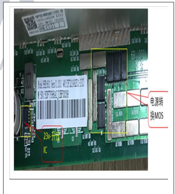
图 3、S17e 运算板正面各关键电路
