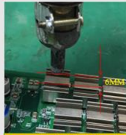
4.3. 风枪嘴离散热片的距离要保持在6MM，停留时间为16±4秒左右，可取掉散热片
